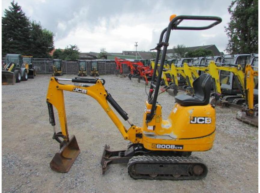
Baujahr 2015, 1128 h, Gesamtgewicht 950 kg, 12,9 kW, 1 Löffel, Verstellfahrwerk, Arbeitsscheinwerfer, hydraulische Zusatzleitung, Gummikette 80 %, Rundumkennleuchte
