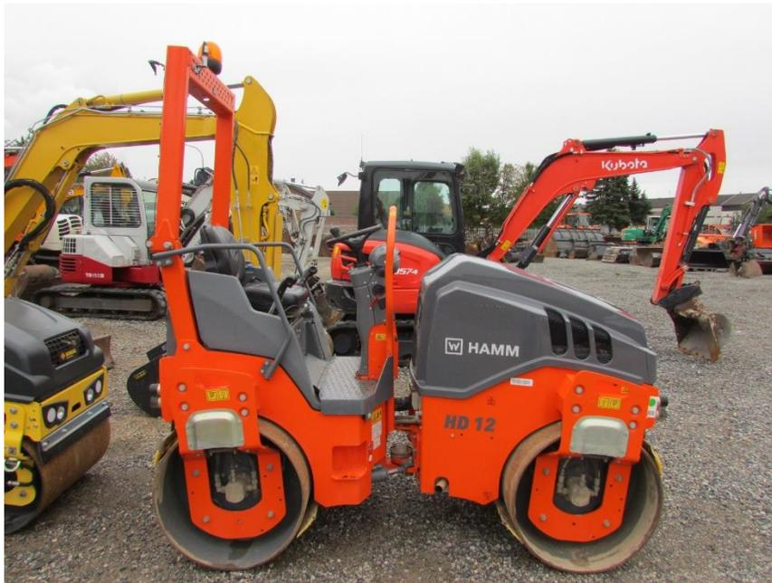
Baujahr 2019, 257 h, Betriebsgewicht 2695 kg, Arbeitsbreite 1200 mm, Motorleistung 22,9 kW, Kubota Motor, ROPS / Schutzbügel, Not-Aus, Arbeitsscheinwerfer, Wasserberieselung, Bandagenabstreifer, Rundumleuchte, Vibration und Antrieb vorne und hinten, zentrale Hebeöse
