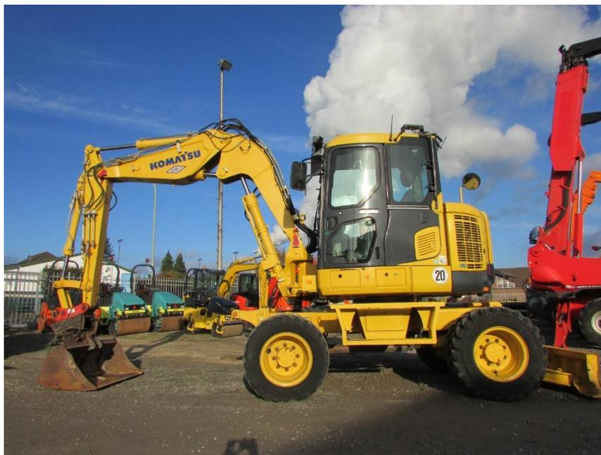
Baujahr 2011, 5551 h, Gesamtgewicht 13500 kg, Verstellausleger, Motorleistung 72 kW, Arbeitsscheinwerfer, Schildabstützung, Schnellwechsler Lehnhoff MS 08, 1 Grabenräumlöffel schwenkbar, volle Verrohrung (Hammer, Greifer, Schere), Radio
